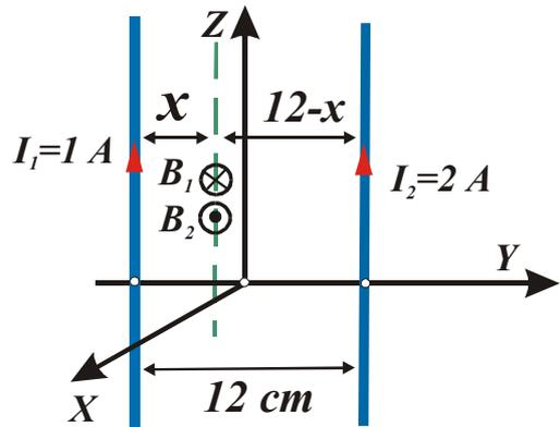
paralelos e indefinidos situados a distancia  $d$  uno del otro, puede demostrarse fácilmente –ver Electromagnetismo en esta misma sección – que la fuerza por unidad de longitud entre ambos conductores es:
